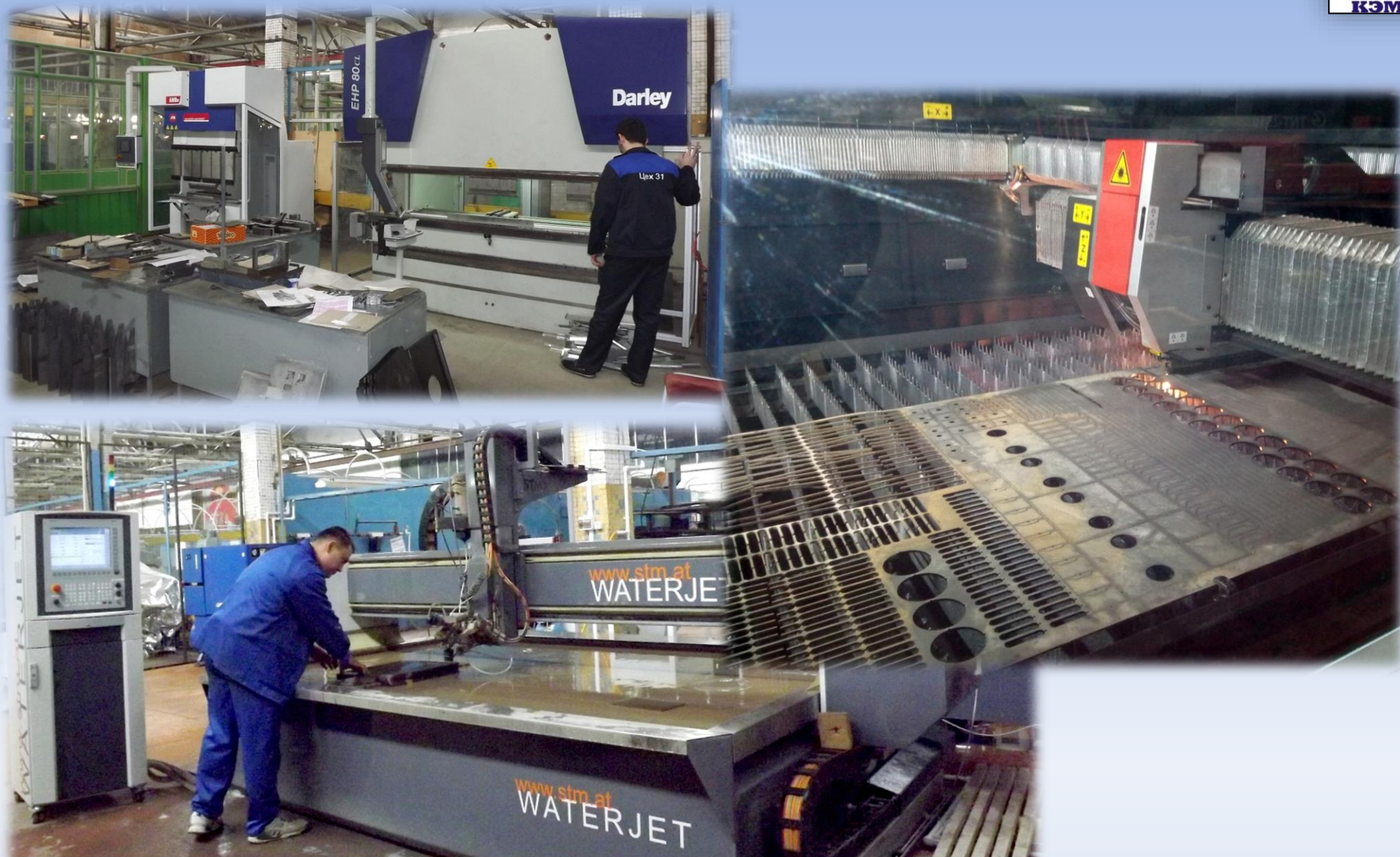
Станок гидроабразивной резки листового материала WATERJET (Австралия)
